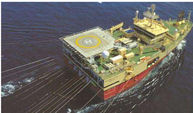
Pour l'acquisition des données, on utilise, en milieu marin, plusieurs hydrophones. Ces appareils permettent de transformer les oscillations acoustiques en oscillations électriques, qui seront ensuite traitées par des systèmes informatisés, qui sont différents suivant la méthode de prospection utilisée
