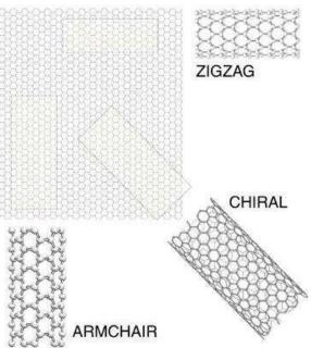
Ces différences d'hélicité donneront aux nanotubes de carbone des propriétés différentes. Notamment, en ce qui concerne les propriétés électriques. Un nanotube de carbone de chiralité sera métallique. Sinon, il sera semi-conducteur. Donc, un nanotube de carbone chaise sera toujours métallique tandis qu'un nanotube zigzag ou chiral sera soit métallique, soit semi-conducteur.
