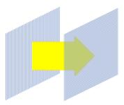
En présence de courant électrique, les cristaux vont progressivement s'aligner dans le sens du champ électrique, la lumière va donc pouvoir traverser la 2eme plaque.
