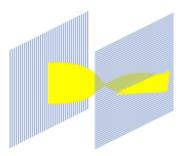
Il est ensuite possible de contrôler localement l'orientation des cristaux, on peut alors former des pixels. On peut différencier deux types d'écrans plats selon le système de commande, utilisant des transistors, permettant de polariser les cristaux :
