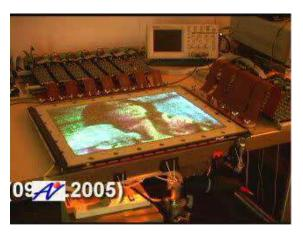
La société Applied Nanotech a également travaillé sur un prototype d'écran utilisant la technologie des nanotubes de carbone. Ils sont d'ailleurs les premiers à avoir produit un écran couleur de ce genre. L'écran est bien sûr de basse qualité mais c'est un prototype qui fonctionne correctement. L'écran est un 22 pouces, avec une résolution de 280 x 200 pixels.
