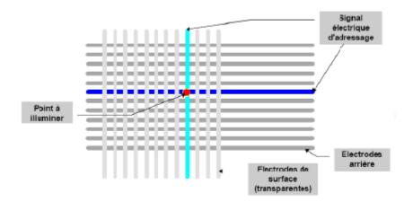
En modulant la valeur de la tension appliquée entre les électrodes et la fréquence de l'excitation il est possible de définir jusqu'à 256 valeurs d'intensités lumineuses.
