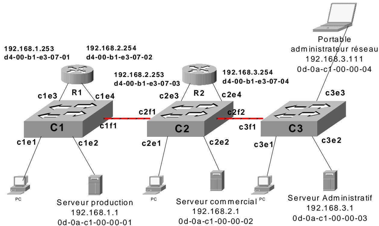
**Légende :** c1e1 signifie : premier port Ethernet du commutateur C1. c1f1 signifie premier port fibre optique du commutateur c1.
