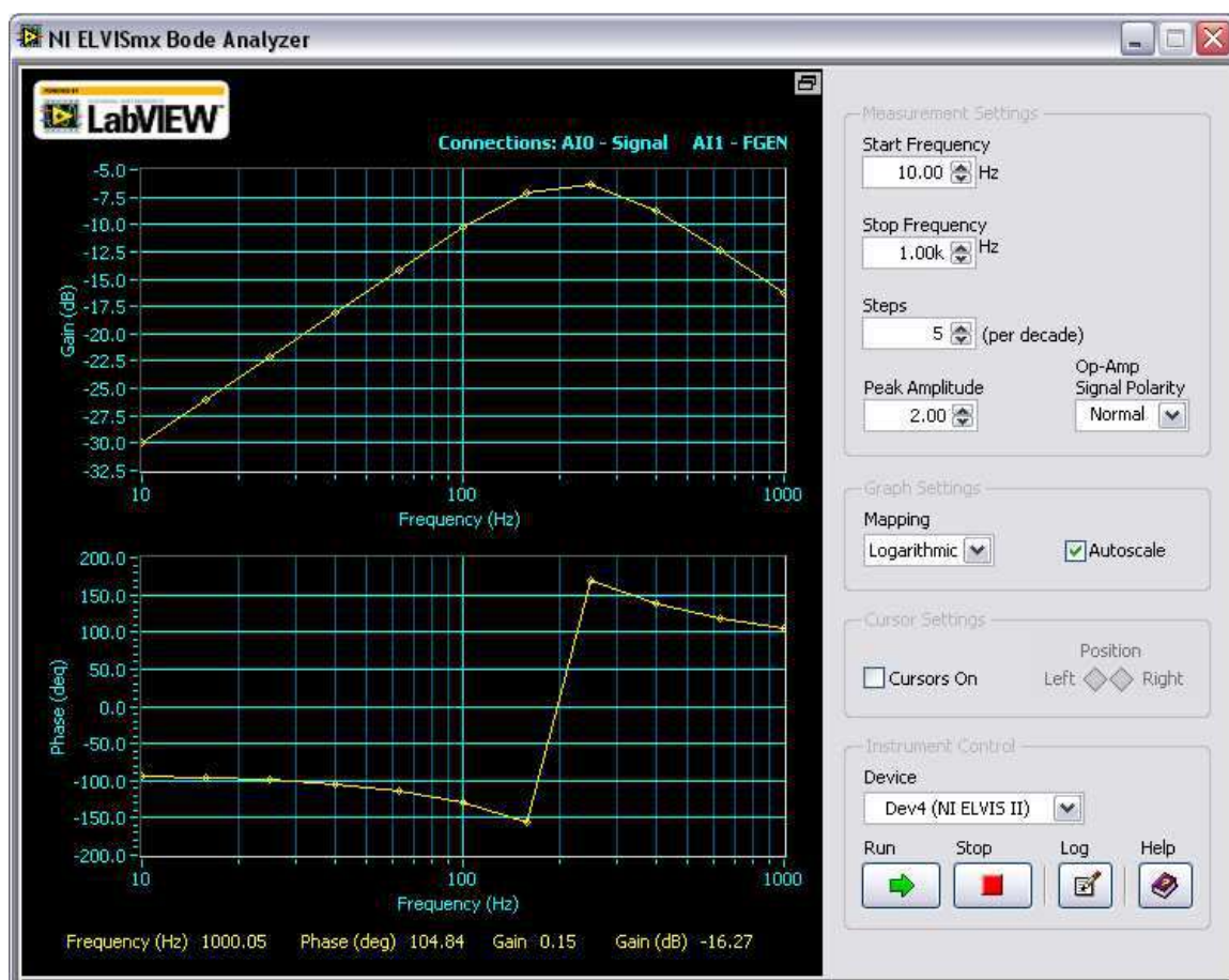
Figure E3-2. Vérification de la réponse en fréquence d'un circuit réel
