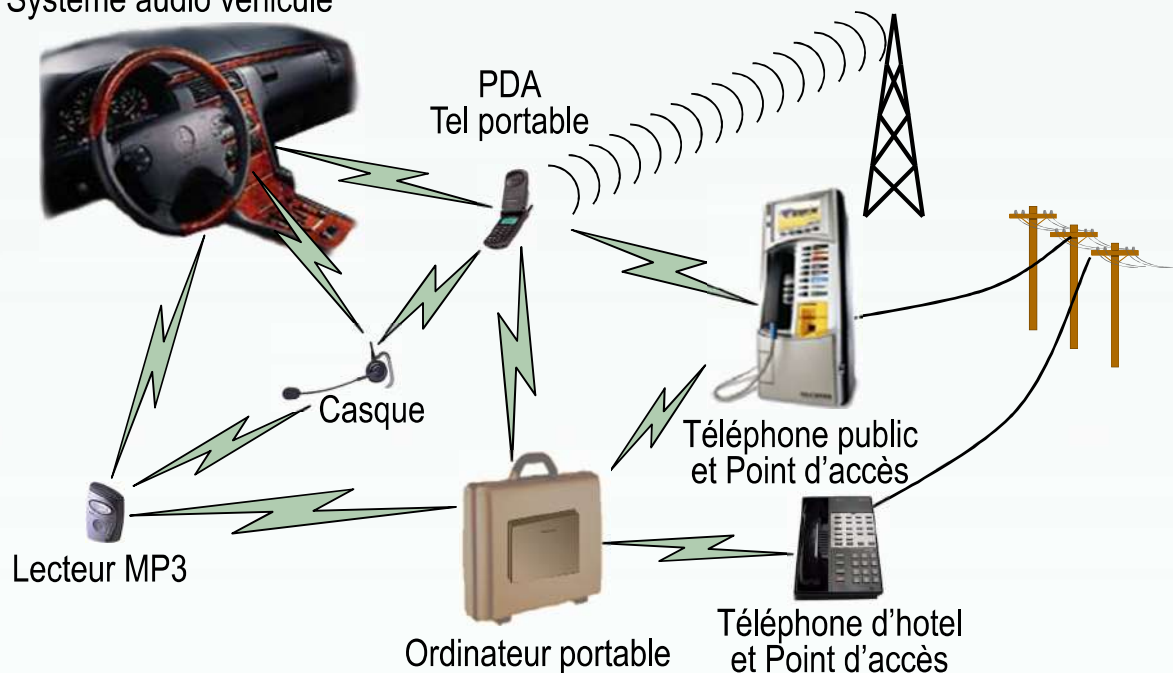
2-Exemple d'équipements de communication dans un réseau
